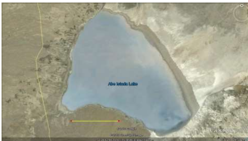
شکل ۴-۵ ب: جهیل اب ایستاده در امتداد شکستگی چمن - کوبه واقع است. این شکستگی باعث فرو رفتگی گردید. این جهیل در سال های آخر خشک گردیده است. بنا بر آن از آن استفاده نمیشود.
